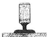
Juster fodpladen og keramikringen. Mindsk svejsestrømmen, forhøj foranhold
